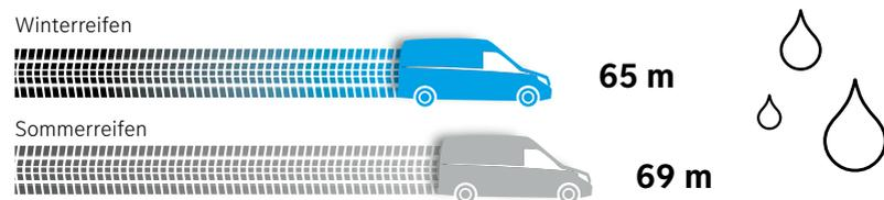
ABS-Bremsverzögerung von 100 auf 0 km/h bei 5°C Außentemperatur auf nasser Straße.
